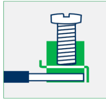
Schraub-Anschluss-System RK Zugbügel-Prinzip
